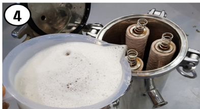
4. 혼합한 시료(액상차 50L + 이물질 50ea)를 여과필터가 설치된 여과기에 투입한 후 여과공정을 시작한다.
